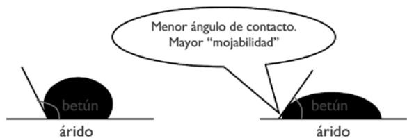
Fig 2. Mejora del ángulo de contacto mediante empleo de tensoactivos
