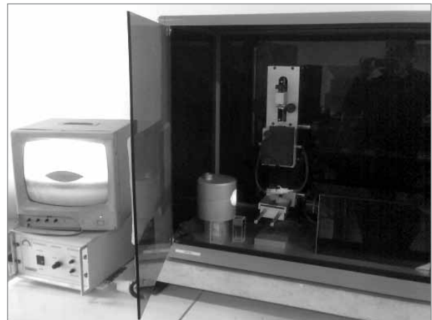
Foto 1. Goniómetro para la determinación de ángulos de contacto.
