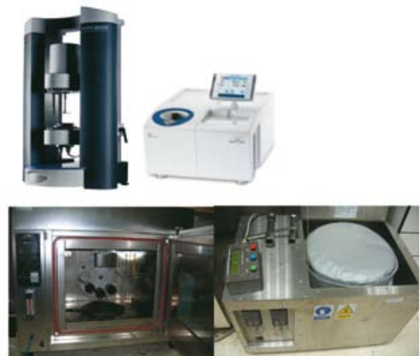
Fig. 3. Equipos empleados: Reómetro, Calorímetro, estufas de envejecimiento RTFOT y PAV
